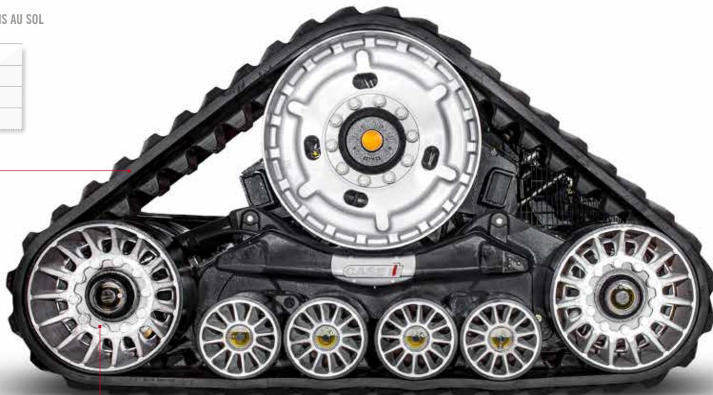
TOUT EST DANS LE DÉTAIL : LES TENDEURS EXTÉRIEURS SONT PLACÉS PLUS HAUTS QUE LES ROULEAUX. CE QUI GARANTIT UNE PROTECTION MAXIMALE DU SOL PENDANT LES VIRAGES ET RÉDUIT L'USURE EN CONDUITE SUR ROUTE.
