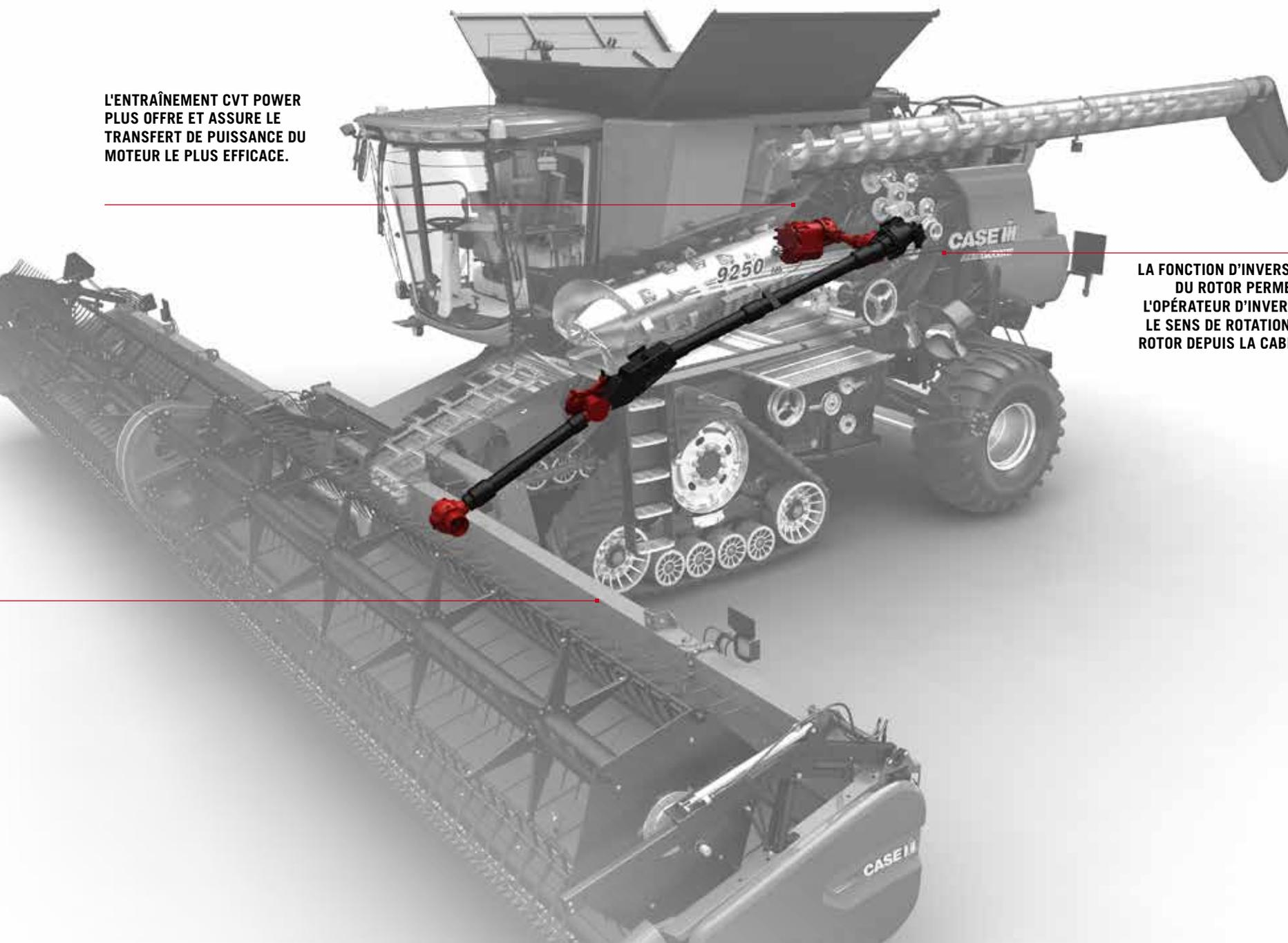
**LA FONCTION D'INVERSION DU ROTOR PERMET À L'OPÉRATEUR D'INVERSER LE SENS DE ROTATION DU ROTOR DEPUIS LA CABINE.**
