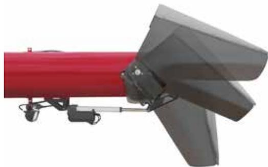
L'option d'embout sur pivot est actionnée avec le levier multifonction. Elle oriente le flux de grains dans la benne et permet de la remplir au maximum sans débordement.
