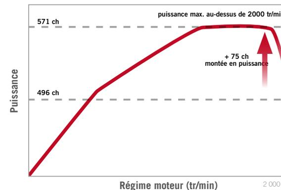
Une réserve de puissance élevée et des caractéristiques de puissance constante garantissent un fonctionnement homogène, aussi bien sur terrain vallonné que dans des conditions de récolte versée
