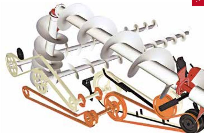
Entraînements séparés pour les vis de vidange verticales et horizontales et vis transversales de la trémie à grain pour pouvoir vider entièrement la vis de vidange
